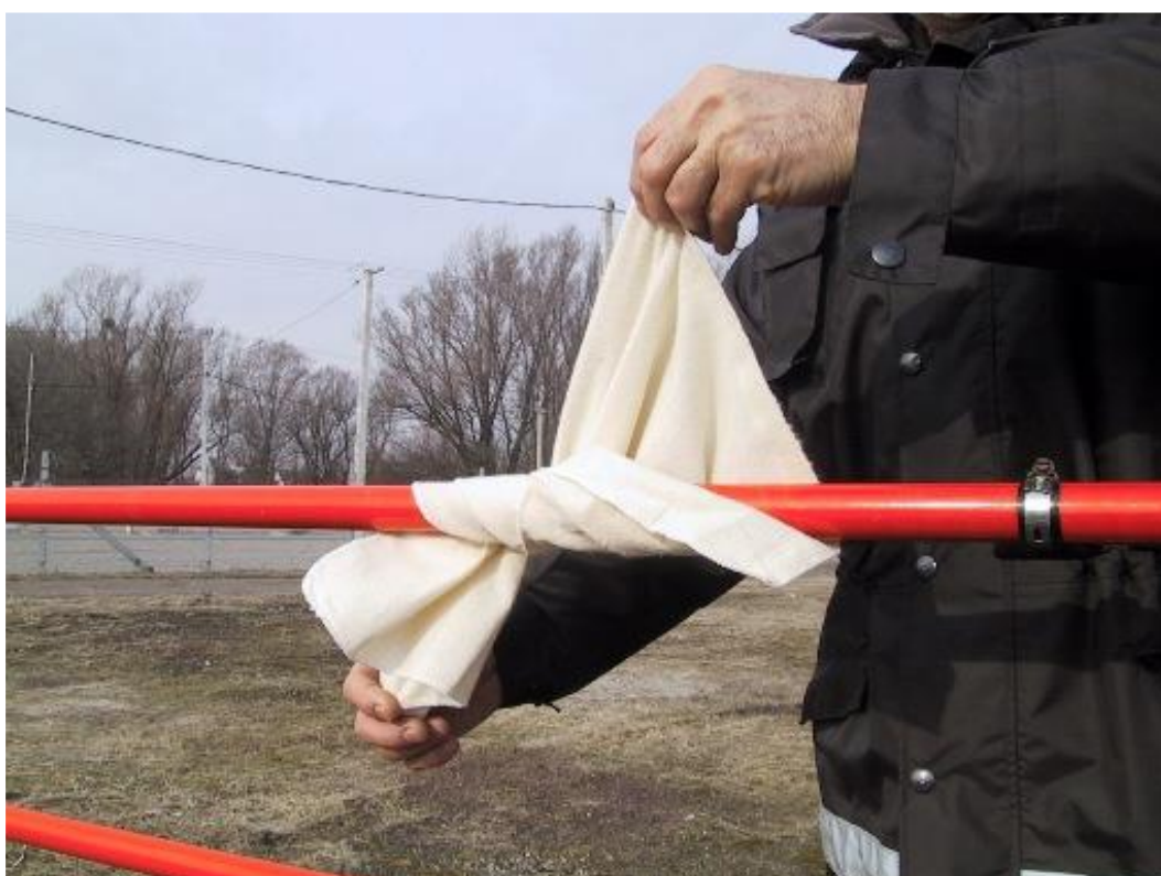
Exemple de utilizare a unei lavete siliconate pentru curățarea unei prăjini electroizolante.
