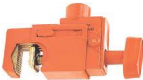
Fig. 1 Exemplu de funie de ajutor clemă șunt pentru firide, izolată la 1 kV, pentru secțiuni rotunde, cu mufă mamă pentru cablu șunt
