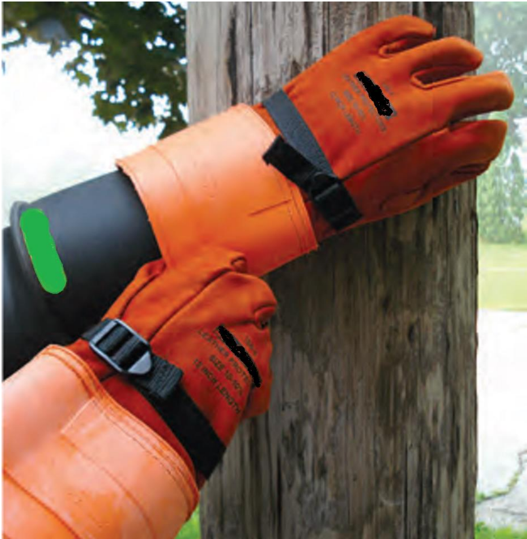
Exemplu de utilizare a unor mănuși electroizolante protejate la exterior cu mănuși de protecție mecanică din piele.
