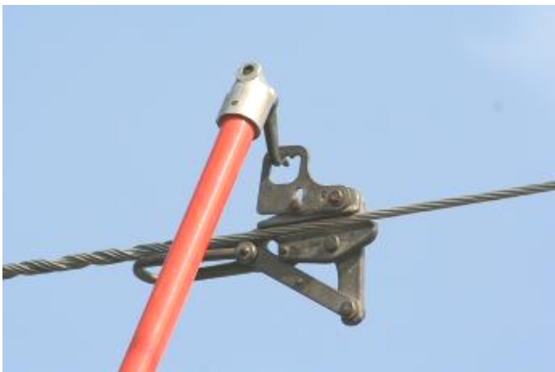
Exemple de utilizare (montare) a unei cleme broască pentru conductoare
