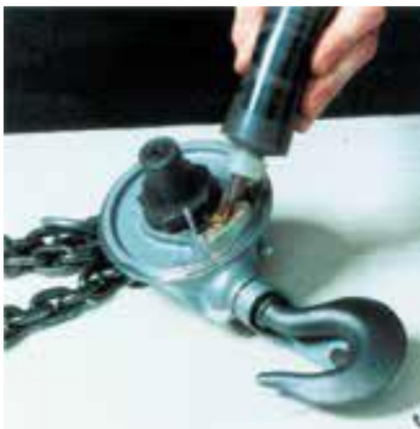
Exemplu de aplicare a lubrifiantului pentru scule.
