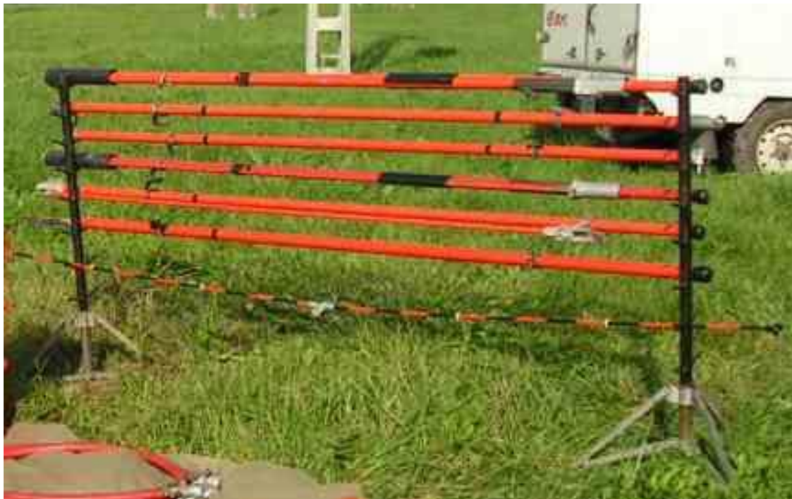
Exemplul de utilizare a rastelului pentru prăjini electroizolante pe durata executării unei lucrări sub tensiune.
