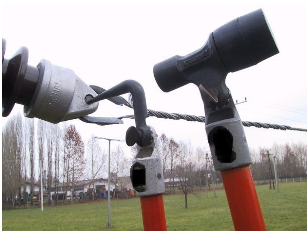
Exemplu de utilizare a axului cotit (dornului) pentru scoaterea unui bolt
