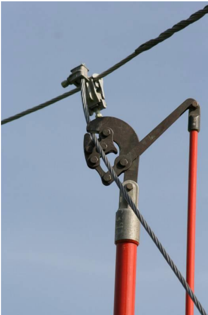
Exemplu de utilizare a prăjinii electroizolante cu FOARFECĂ (pentru secțiuni medii).
