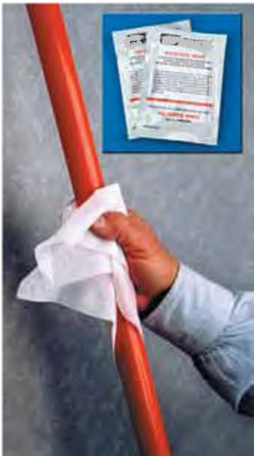
Exemplu de utilizare a unei șervețel pentru curatarea unei prașini electroizolante.
