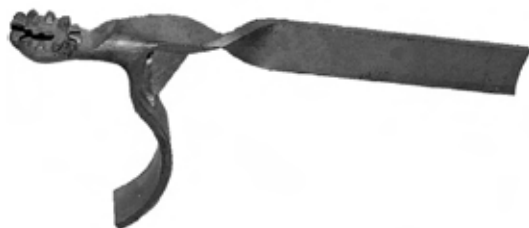
Fig. 2 dispozitive de montarea / demontarea agrafelor
