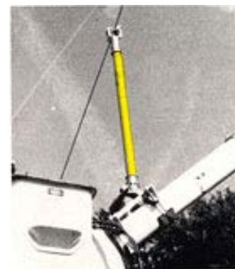
Fig. 3 Exemplu dispozitiv pentru suspendarea temporara a fazelor
